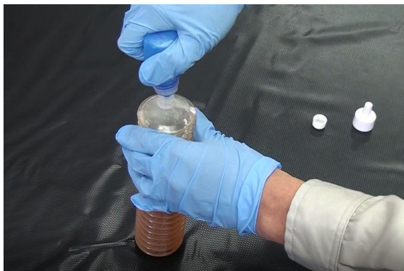
(写真-5) 触媒の添加状況
